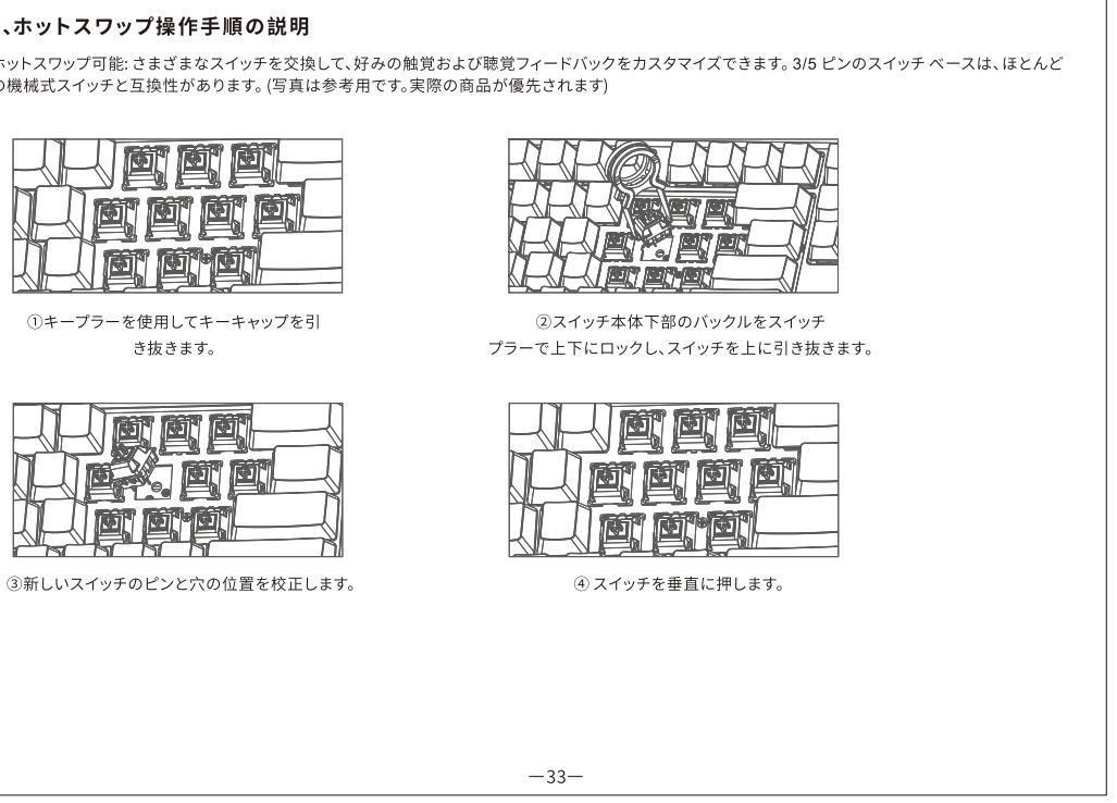
① 键帽拔出器使用时,将键帽拉到上部,然后将键帽拉出。
